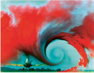
Abbildung 9: Tipverlust an einer Flugzeugtragfläche. Quelle: NASA Langley Research Center
