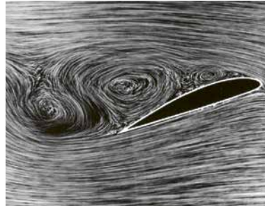
Abbildung 10: Strömungsfilm an einem Rotorblattprofil mit Abriss. Quelle: DLR- Archiv Göttingen
