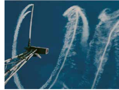
Abbildung 11: Drallverlust an einem WKA. Quelle: Risoe National Laboratory Denmark
