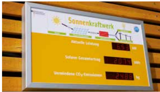
Abbildung 15 Anzeigetafel für eine Solaranlage
