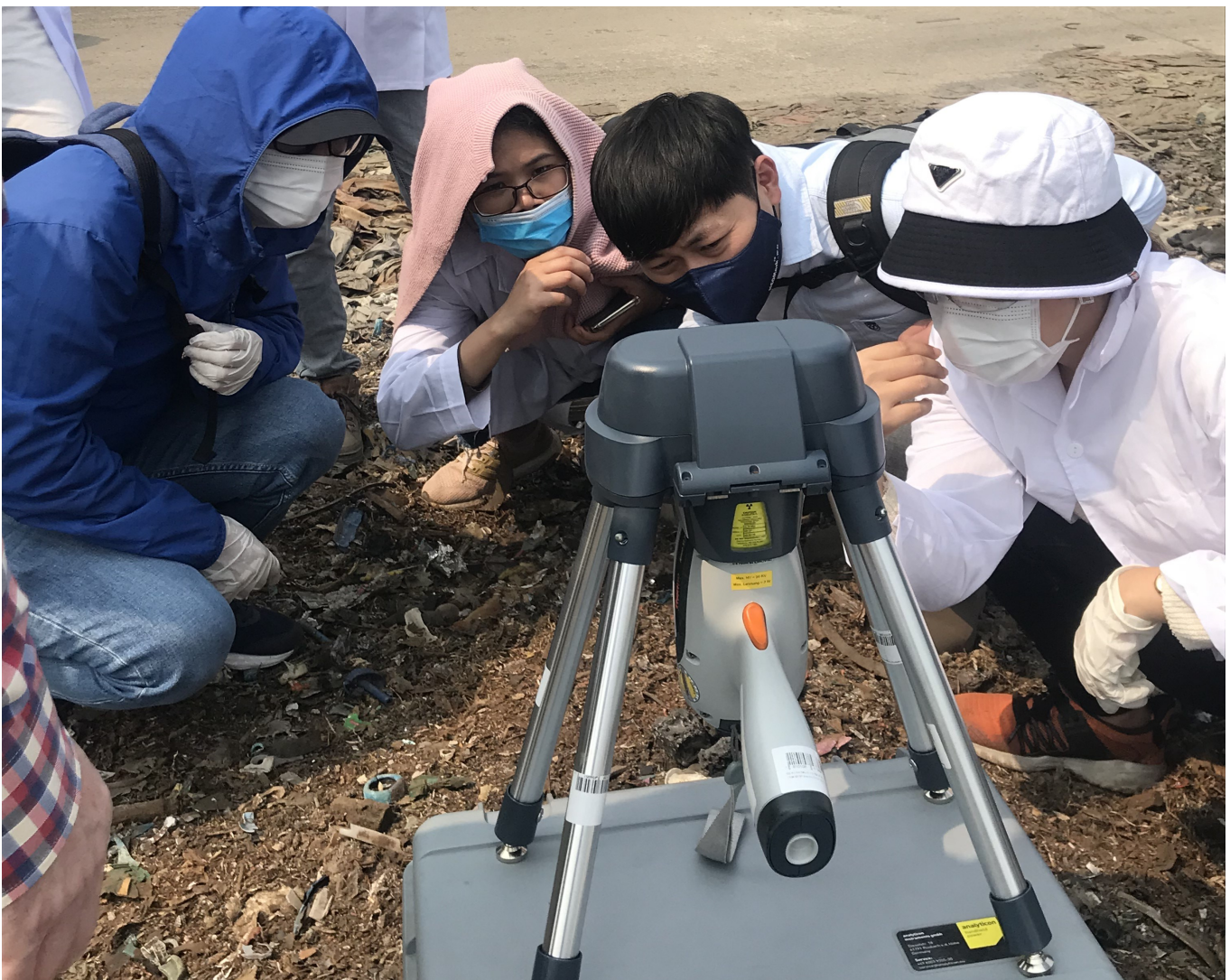
Abbildung 5: Messung von Abfällen mit einem mobilen Röntgenfluoreszenz-Spektrometer.
