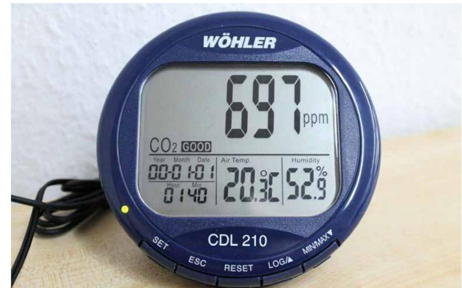
Der Wöhler CDL 210 CO<sub>2</sub>-Datenlogger ist ein CO<sub>2</sub>-Messgerät zur kontinuierlichen Überwachung der Kohlendioxid-Konzentration (in ppm) und weiterer Qualitätsfaktoren der Luft.
