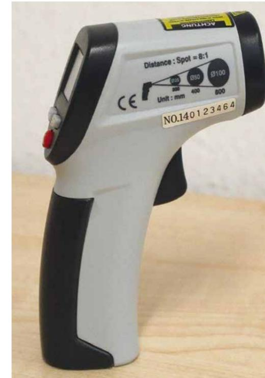
Das IR-260-8S ist ein Messgerät zur berührungslosen Temperaturmessung. Es bestimmt die Temperatur anhand der Infrarotenergie, die von einem Objekt emittiert wird. Es ist besonders nützlich für die Temperaturmessung von heißen, schwer zugänglichen oder beweglichen Objekten. Das Thermometer misst die Oberflächentemperatur eines Objektes. Es kann nicht durch transparente Oberflächen wie Glas oder Plastik hindurch messen.
