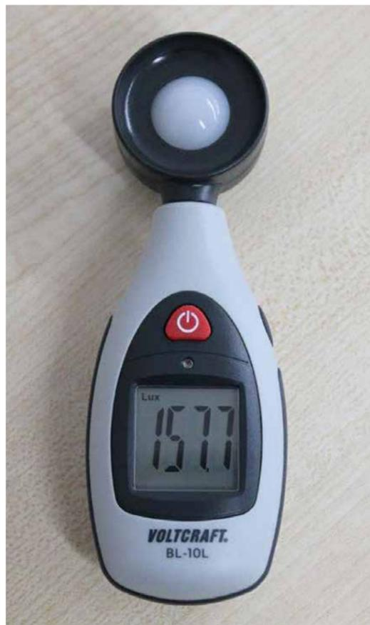
Das Gerät dient der Messung der Beleuchtungsstärke und des Lichteinfalls auf eine bestimmte Fläche (z. B. Arbeitsplatz).
