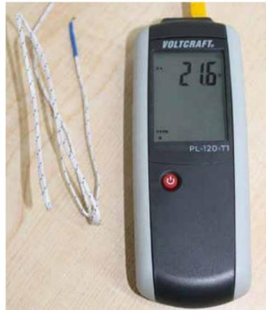
Das Gerät dient zur Temperaturmessung und eignet sich besonders für den Einsatz in Laboren oder industriellen Bereichen. Die Temperaturmessung erfolgt über ein Thermoelement.
