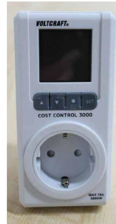
Das Energiekosten-Messgerät dient zum Messen und Analysieren von Verbrauchsdaten elektrischer Geräte. Das Messgerät wird einfach zwischen Steckdose und Elektrogerät gesteckt und benötigt keinen weiteren Installationsaufwand. Der Betrieb ist nur an einer handelsüblichen Schutzkontakt-Steckdose mit einer Nennspannung von 230 V/AC zulässig. Die max. Nennleistung darf 3680 Watt nicht überschreiten.
